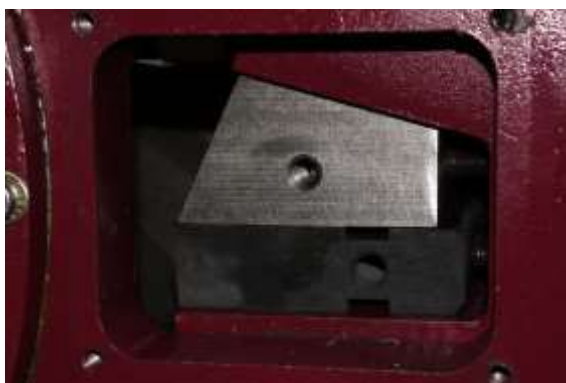
Fig. 8.4 Lame fisse integrali e cuneo di fissaggio
