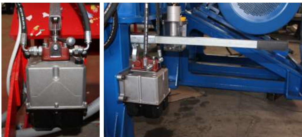
Fig. 6.9 Serbatoio olio posto sotto la pompa manuale. La leva sul serbatoio è progettata per invertire la pressione dell'olio nel cilindro selezionato
