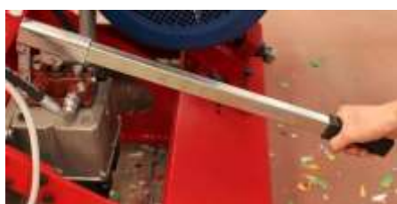
Fig. 3.10 Pompa manuale idraulica
