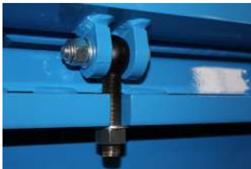
Fig. 8.1 Bulloni per il supporto griglia
