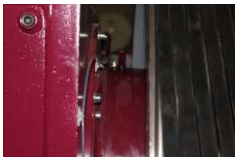
Fig. 5.11 Lubrificazione automatica dei cuscinetti lato volano
