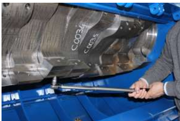
Fig.8.9 Serrare le viti con una chiave dinamometrica
