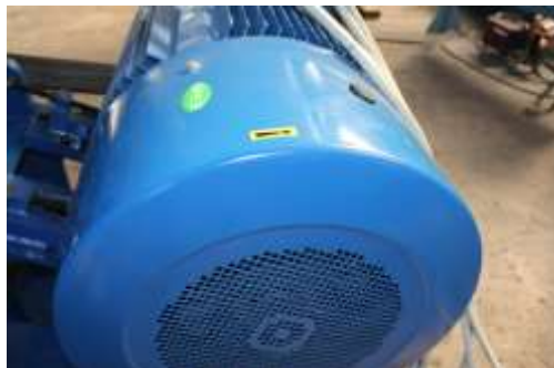
Fig. 7.1 Freccia indicante il senso di rotazione (senso orario)
