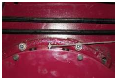
Fig.5.12 Lubrificazione automatica della sede cuscinetti
