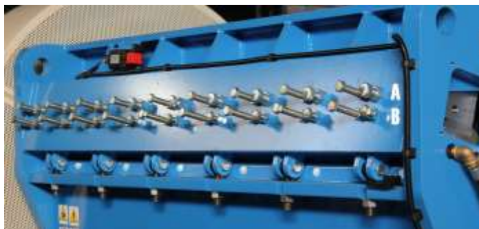
Fig. 8.3 Le viti superiori (A) sono progettati per la regolazione del cuneo, le viti inferiori (B) sono progettate per la regolazione della lama fissa
