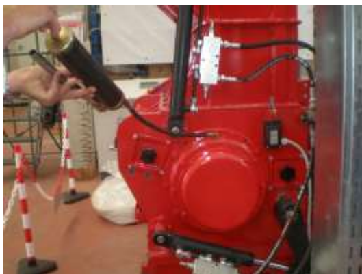
Fig.5.11/A Lubrificazione manuale dei cuscinetti
