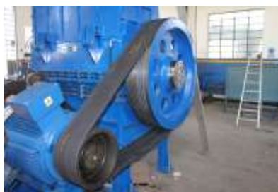
Fig. 6.1 – Cinghie poste tra la puleggia motrice e il volano
