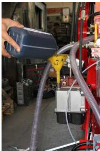
Fig. 6.9/A Riempimento olio del serbatoio della pompa idraulica manuale
