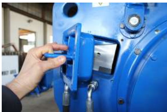
Fig. 8.2 Portella ispezione lame fisse
