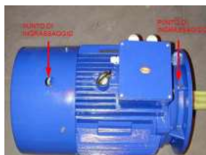
Fig. 3.14 – Ingrassaggio con grasso del motore
