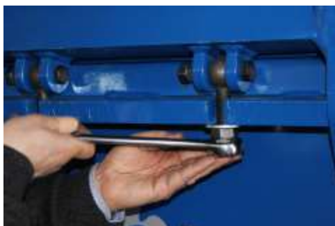
Fig. 8.6 Serrare i bulloni del porta griglia nella posizione finale
