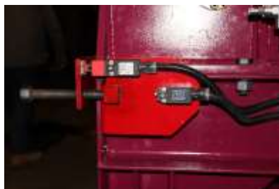
Fig. 4.2 Dispositivo di sicurezza con perno filettato e micro di sicurezza con chiusura a chiavetta
