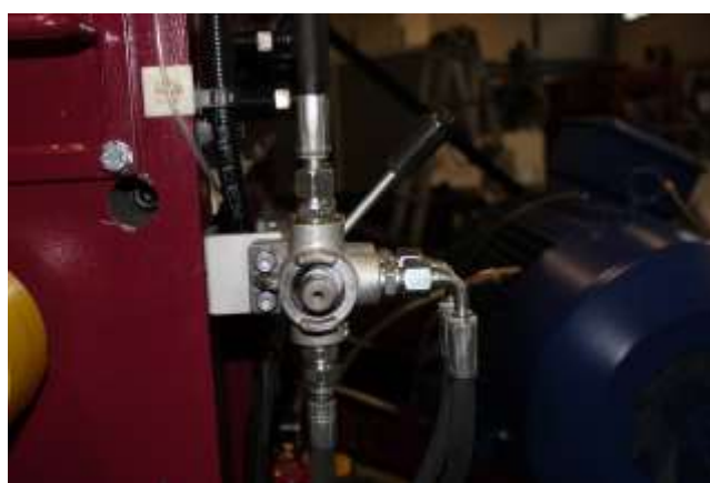
Fig. 6.8 Valvola a 6 vie di deviazione con leva in alto attiva la tramoggia (v. foto); con leva in basso attiva il portagriglia
